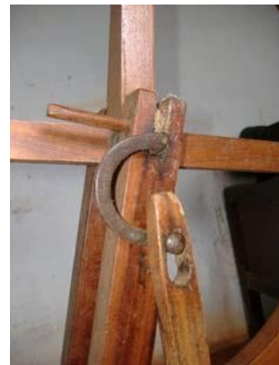
Foto 04- Detalhe do sistema que liga a roda no pedal. Município de Itapagipe - MG Raquel Córdova Christófaro, abril/ 2010
