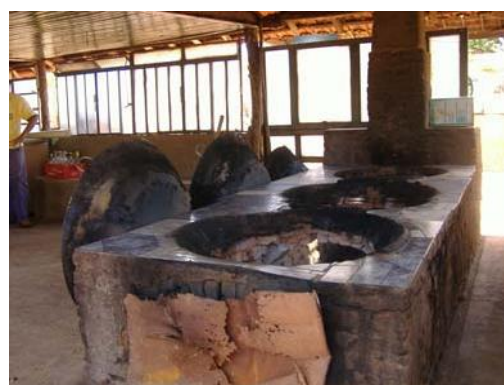
Foto 05- Detalhe do fogão à lenha onde é feita a rapadura. Município de Itapagipe - MG Raquel Córdova Christófaro, abril/ 2010
