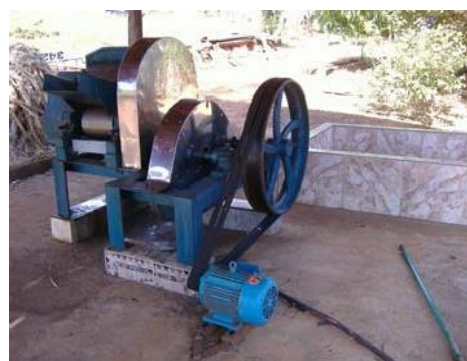
Foto 03- Detalhe da máquina que moe a cana. Município de Itapagipe - MG Raquel Córdova Christófaro, abril/ 2010
